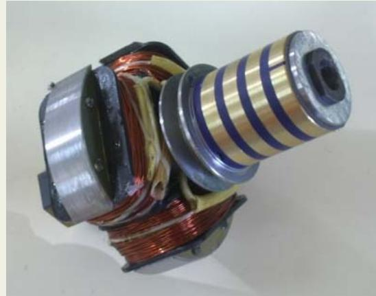
*Rotor bobinado con anillos de un motor de inducción. (M.C. M.)*
